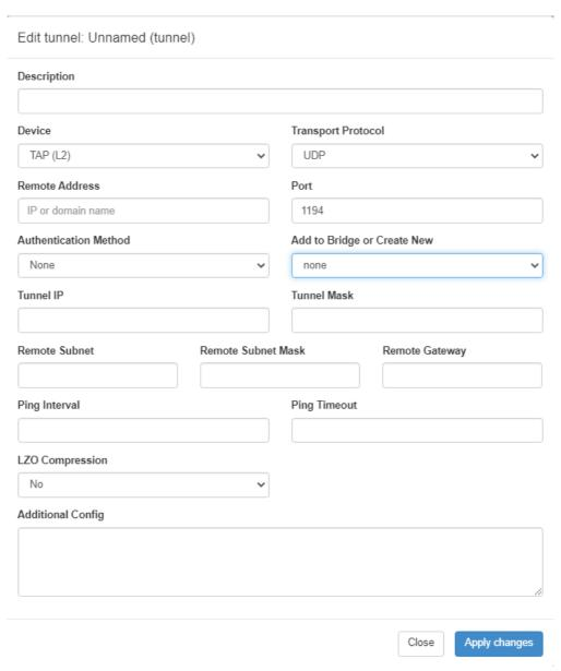
Рис. 4. Пример конфигураций OpenVPN. Настройка OpenVPN
