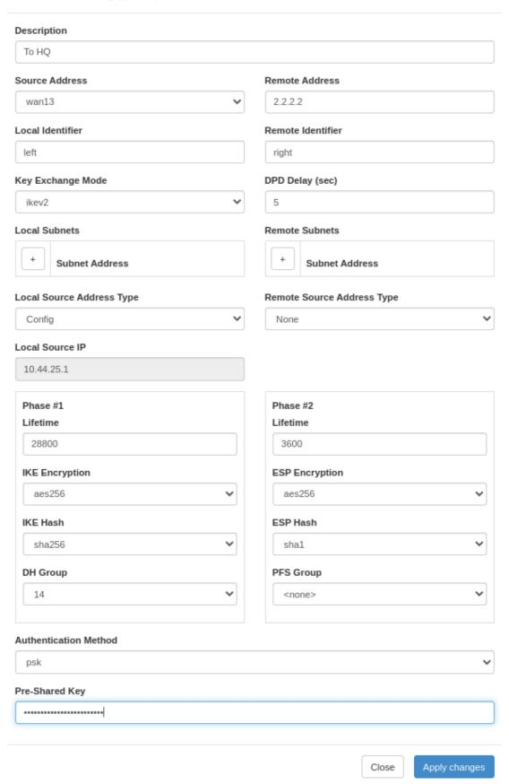
Рис. 14. Примеры конфигураций IPsec. Настройка IPsec-туннеля
