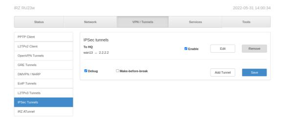
Рис. 13. Вкладка IPSec/Tunnels. Раздел IPSec tunnels
