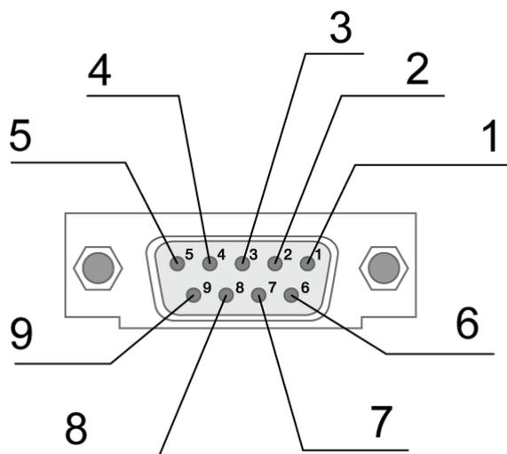
Рис. 2.5.1. Интерфейсный разъем
