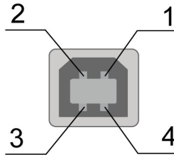
Рис. 2.5.3. Разъём USB
