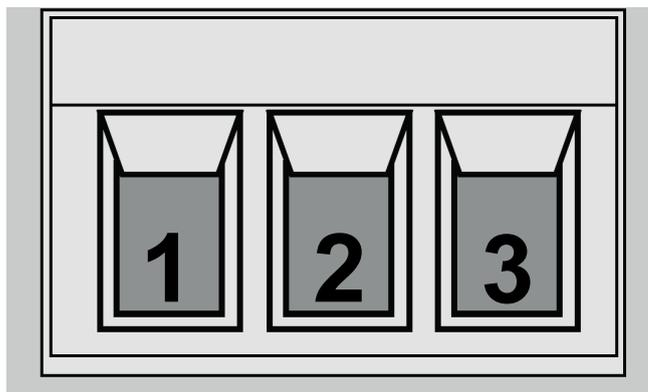
Рис. 2.7 Разрывной клеммный коннектор винтовой – RS485
