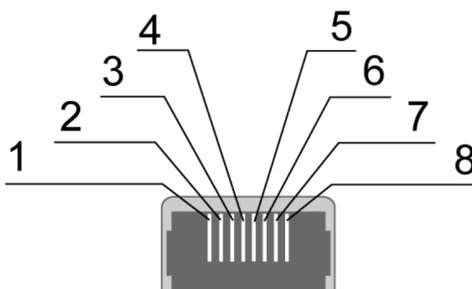
Рис. 2.4 Разъём Ethernet
