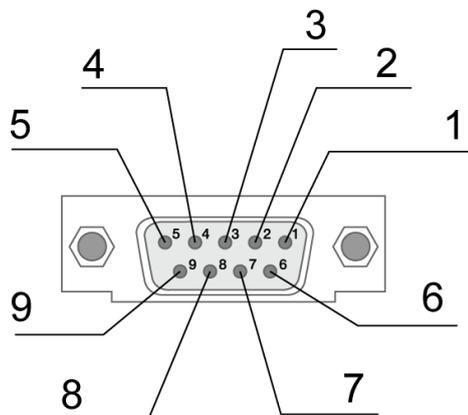
**Рис. 2.6** Разъём DB9-F
