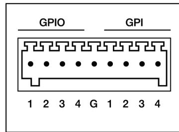
Рис. 9. Интерфейсный разъём
