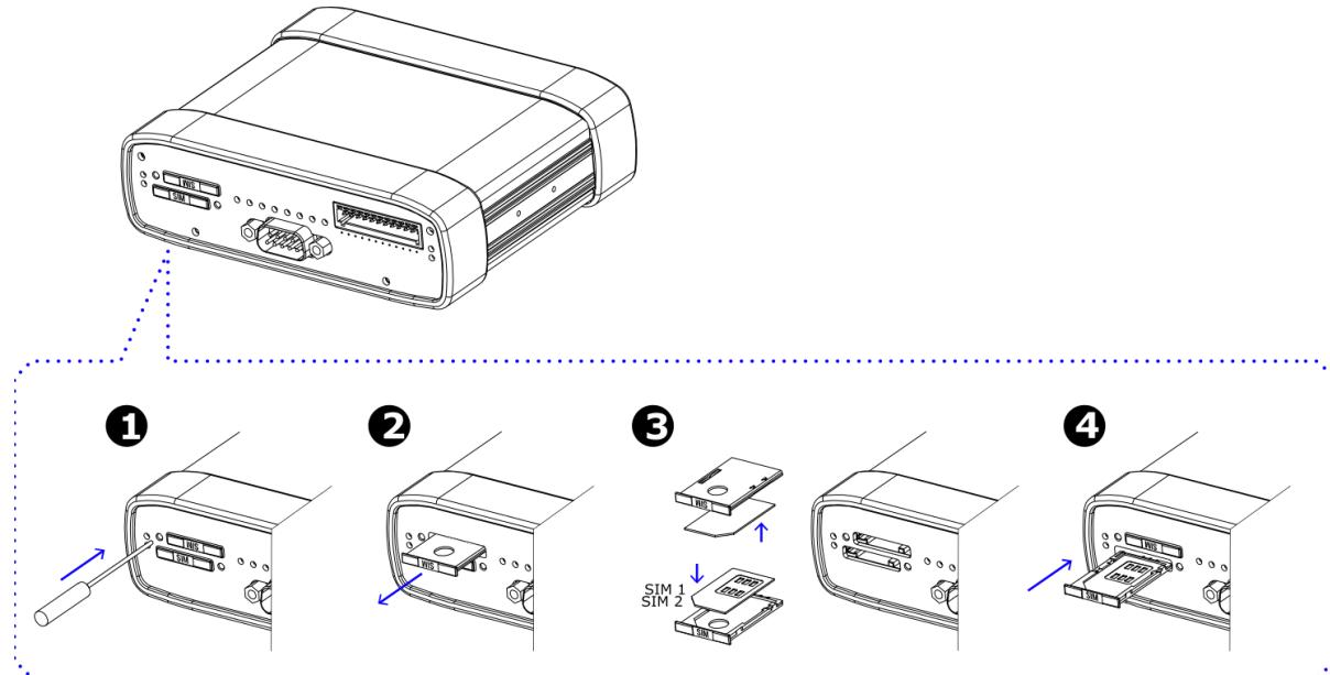
Рис. 10. Установка SIM-карт
