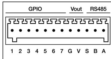
Рис. 8. Интерфейсный разъём
