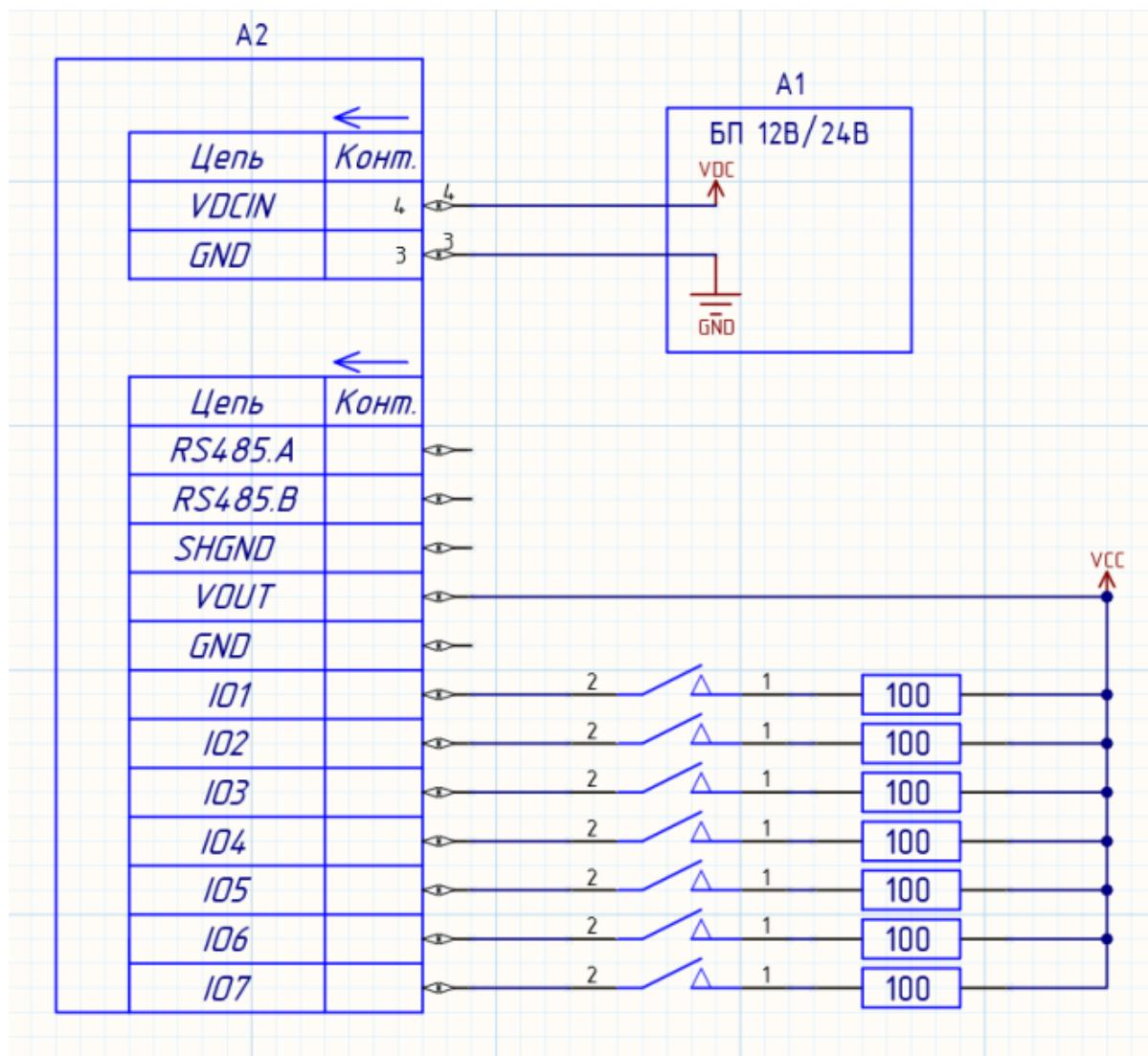
Рис. 16. Пример схемы подключения устройств к GPIO роутера
