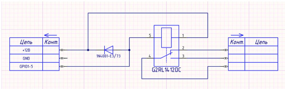
Рис. 17. Схема для подключения электромагнитных реле к GPIO1-GPIO5
