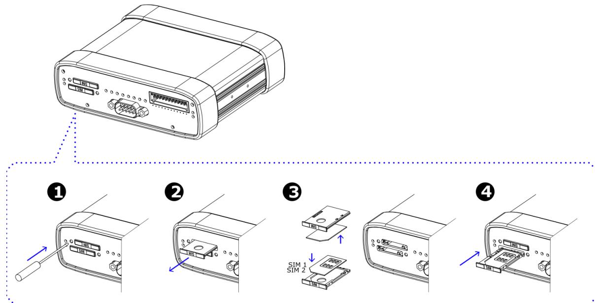
Рис. 10. Установка SIM-карт
