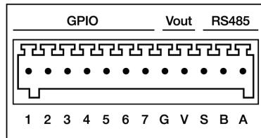
Рис. 8. Интерфейсный разъём
