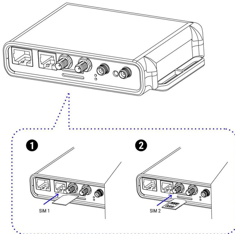
Рис. 6. Установка SIM-карт
