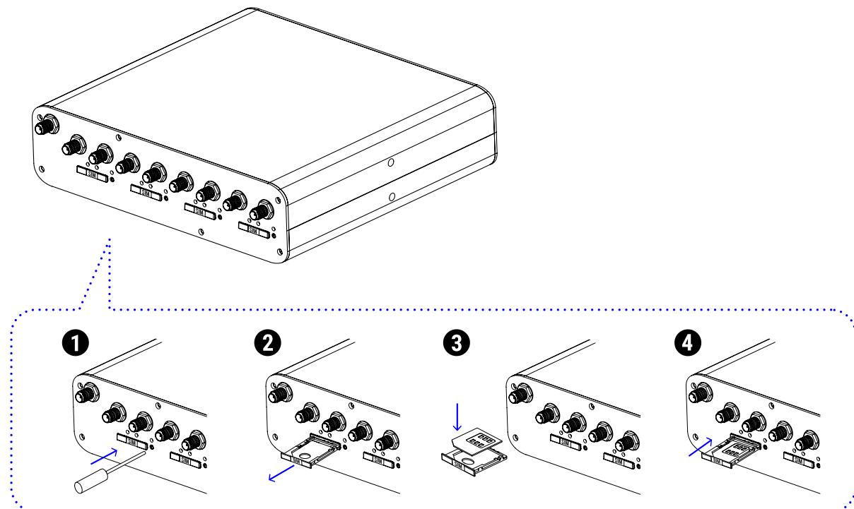
Рис. 9. Установка SIM-карт
