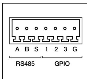
Рис. 7. Интерфейсный разъём
