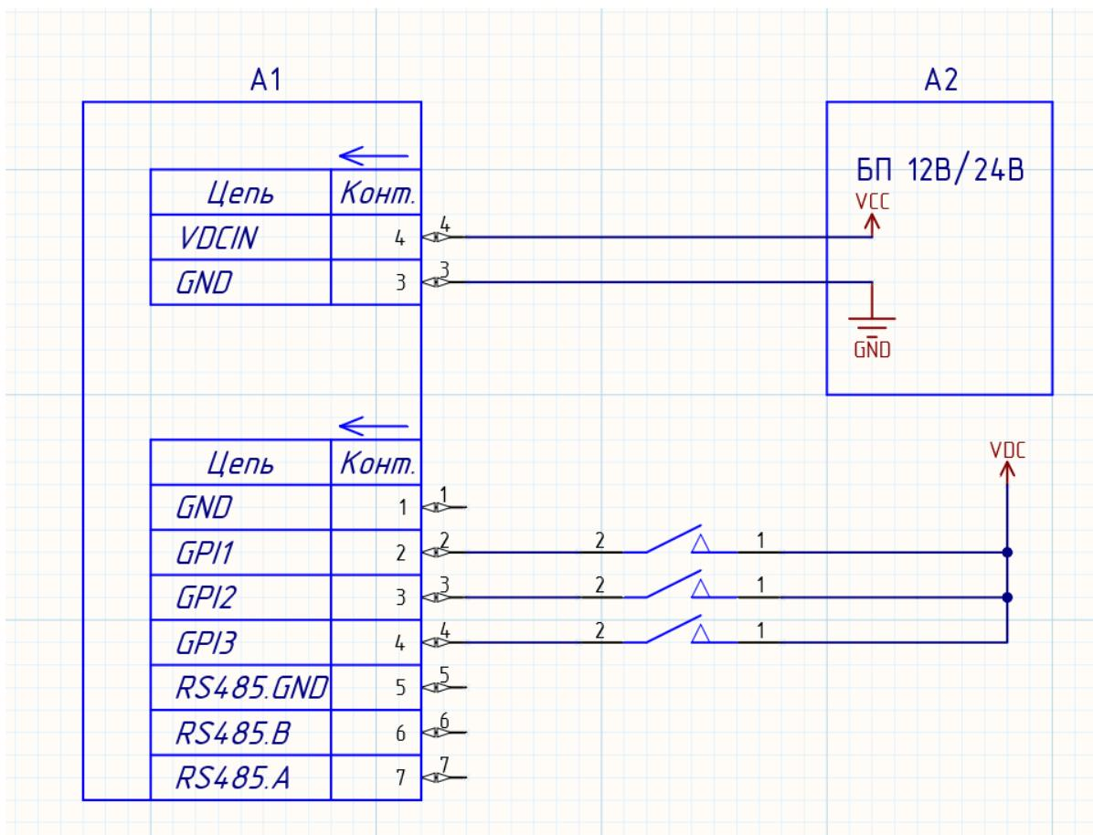
Рис. 15. Пример схемы подключения устройств к GPI роутера
