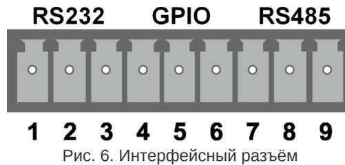
Рис. 6. Интерфейсный разъём
