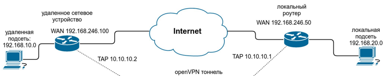
Рис. 9 Примеры конфигураций OpenVPN. Схема сети
