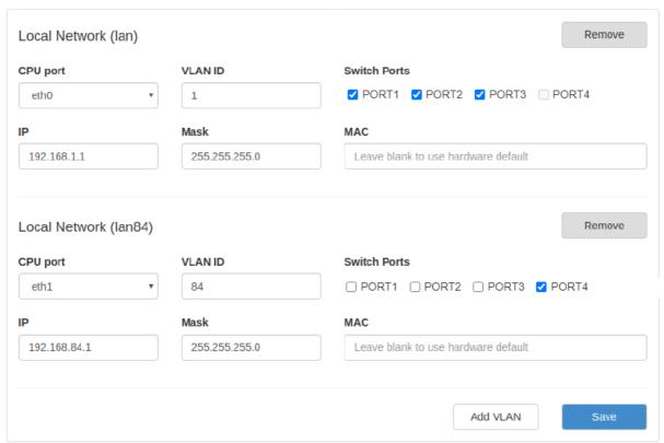
Рис. 6. Вкладка Network, раздел Local Network
