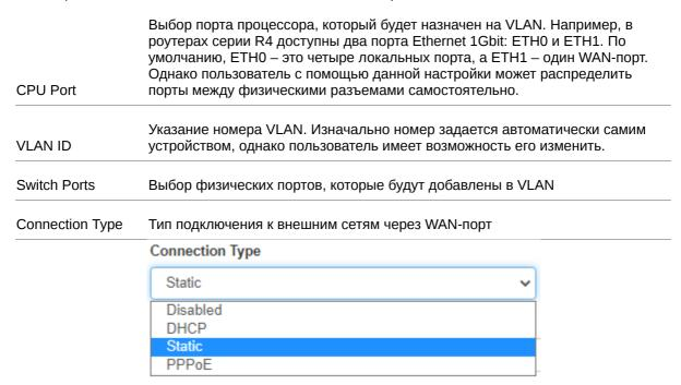
Рис. 8. Тип соединения для WAN-порта
