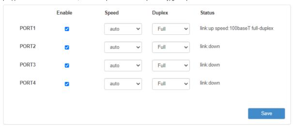
Рис. 22. Вкладка Network, раздел Switch
