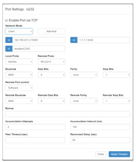
Рис. 47. Вкладка Services, раздел Serial Ports, пример настроек порта RS232
