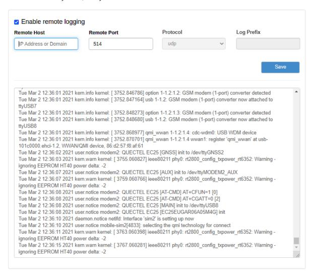
Рис. 61. Вкладка Tools, раздел System Log
