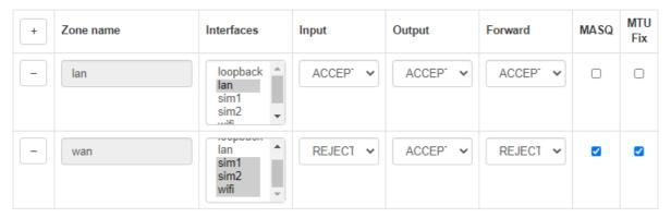
Рис. 30. Вкладка Services, раздел Firewall, настройки Zones List
