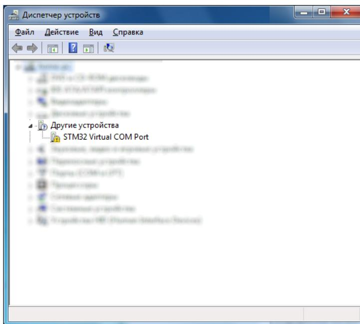
**Рис. 2.2** Операционная система не смогла определить модем ATM
