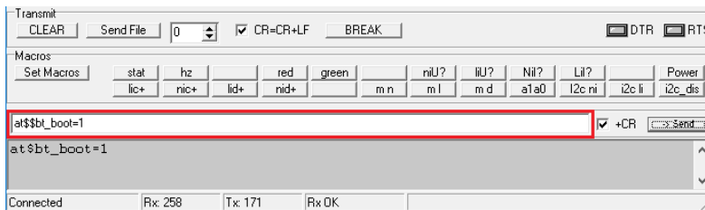
Рис. 3.9 Terminal: команда at$$$bt_boot=1 для переключения модуля Bluetooth в режим обновления
