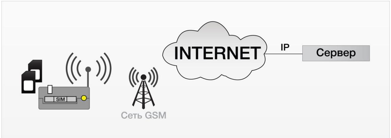
Рис. 4.2 Схема работы с одним сервером без резервирования
