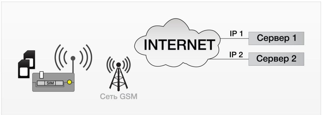
Рис. 4.3 Схема работы с двумя серверами
