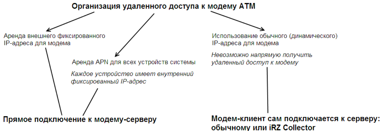
Рис. 4.6 Способы организации удаленного доступа к модему
