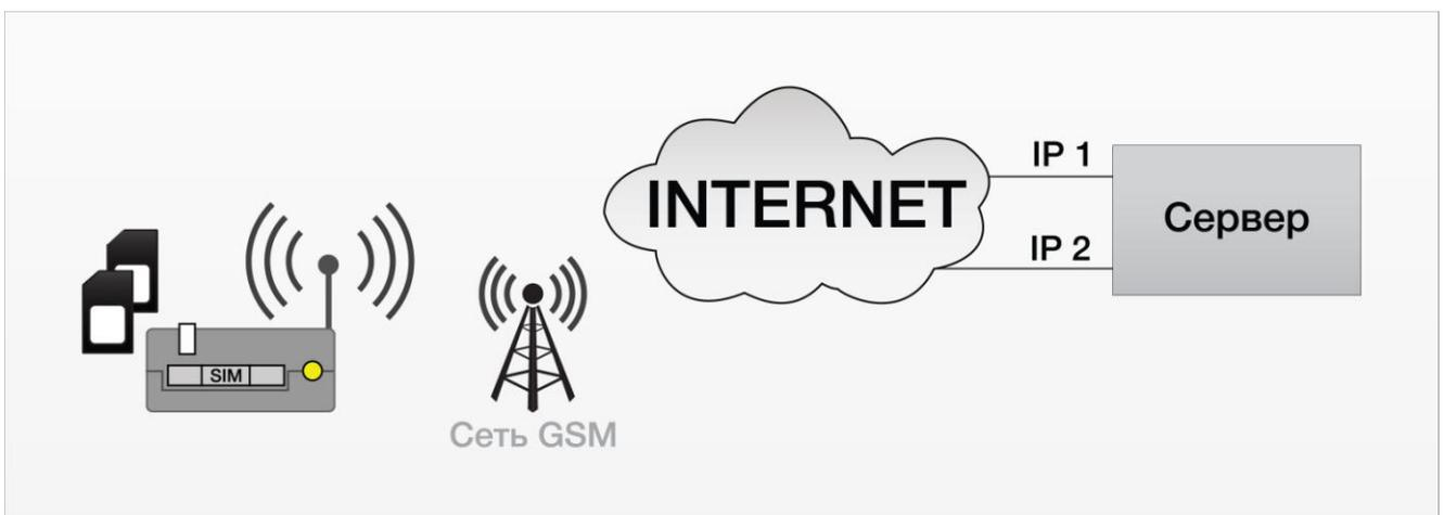
**Рис. 4.4** Схема работы с двумя IP-адресами на одном сервере
