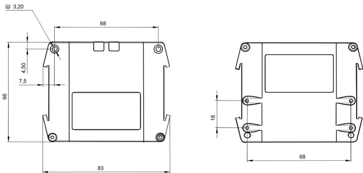
**Рис. 3.6** Габаритные размеры модема ATM – чертеж
