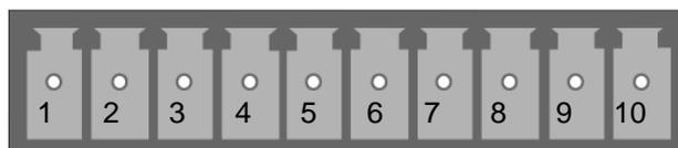
**Рис. 2.5** Разрывной клеммный коннектор
