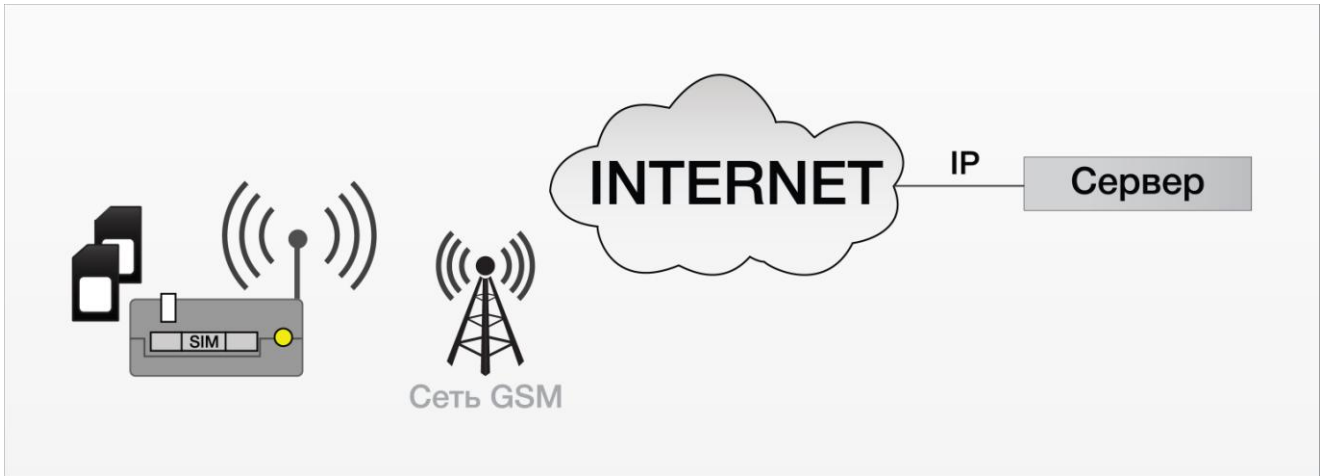
Рис. 4.2 Схема работы с одним сервером без резервирования
